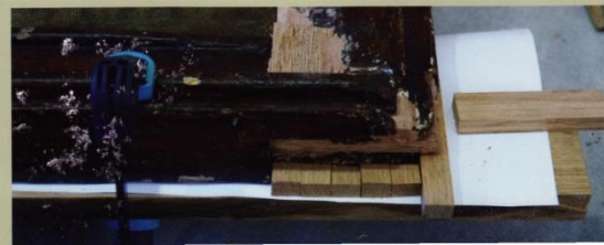
Imagen de la nivelación y unión de los paneles que componen la tabla central.
